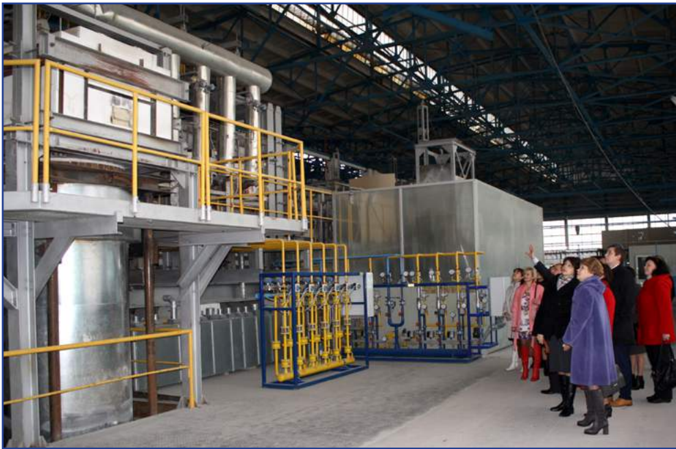
Печь по производству стекла, температура плавления которого составляет 700° С
