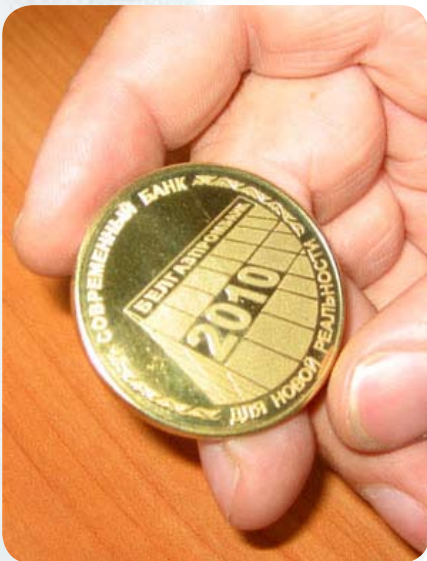
Образец медали Белгазпромбанка, сделанный из латуни. На его основе сделана «матрица», с помощью которой отливали «настоящие» медали
